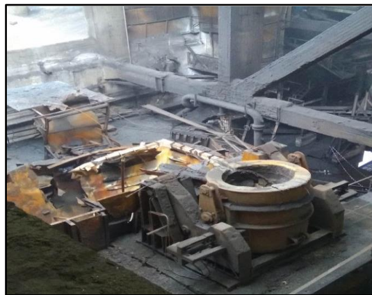
Εικόνα 8: Η μονάδα κοκκοποίησης σιδηρονικελίου όπου έλαβε χώρα το δυστύχημα.
