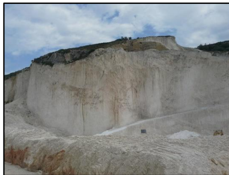
Εικόνα 10: Ανορθολογική εκμετάλλευση λατομείου (πολύ υψηλά μέτωπα/αρνητικές κλίσεις) με εγκυμονούντες κινδύνους για την ασφάλεια των εργαζομένων.
