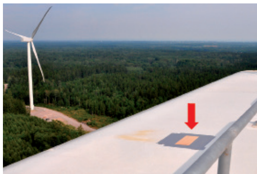
Έχει προταθεί ότι τα χειρόπτερα μπορεί να προσελκύνονται από έντομα γύρω από τις ανεμογεννήτριες: σμήνη μυρμηγκιών πιασμένα σε κολλώδη παγίδα εντόμων (δεξιά φωτογραφία) τοποθετημένη στην άτρακτο (αριστερή φωτογραφία) στη Σουηδία. © J. Rydell
