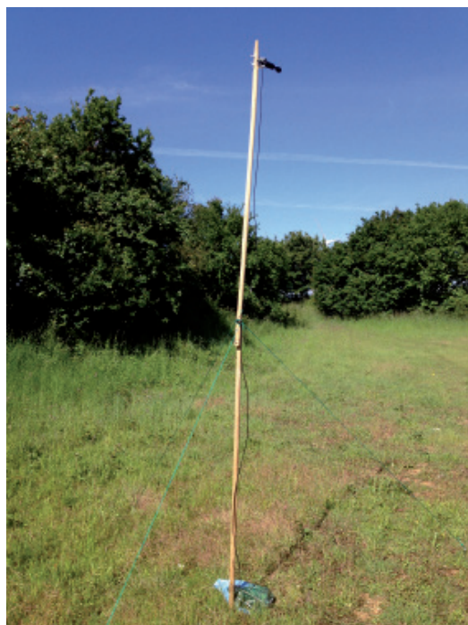
Αυτοματοποιημένος δέκτης υπερήχων χειροπτέρων με μικρόφωνο τοποθετημένο 2 μέτρα πάνω από το έδαφος στη σχεδιαζόμενη θέση τοποθέτησης ανεμογεννήτριας. © J. Sudraud
