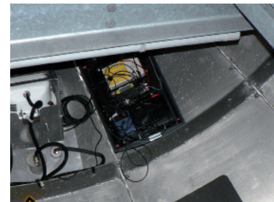
Απομακρυσμένο μικρόφωνο εγκατεστημένο στο κάτω μέρος της ατράκτου (πάνω φωτογραφία) και συνδεδεμένο με αυτοματοποιημένο δέκτη υπερήχων χειροπτέρων μέσα στη άτράκτο (κάτω φωτογραφία). © L. Bach
