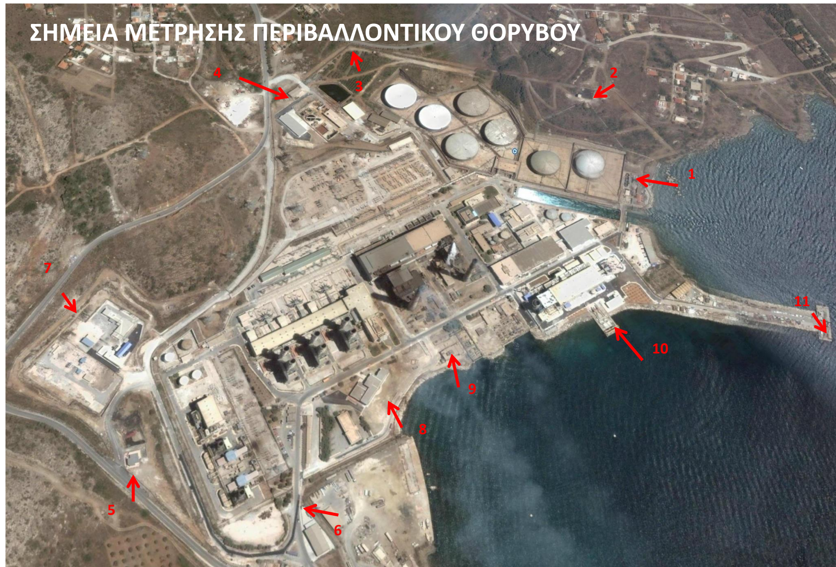
Σχήμα 1. Τοπογραφικό διάγραμμα με τα σημεία μέτρησης της στάθμης θορύβου στα όρια γηπέδου του ΑΗΣ Κερατέας- Λαυρίου
