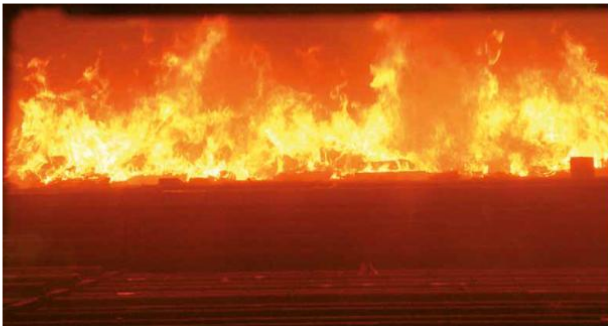
Εικόνα 11-8: Διαδικασία καύσης σε σύστημα κινούμενης εσχάρας
