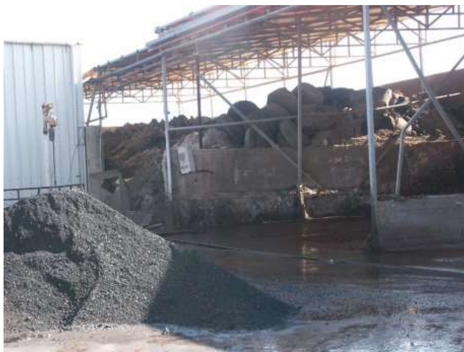
Εικ. 3.3.4: Εργοστάσιο ανακύκλωσης συσσωρευτών μολύβδου όπου διακρίνονται σωροί μολυβδόχων σκωριών
