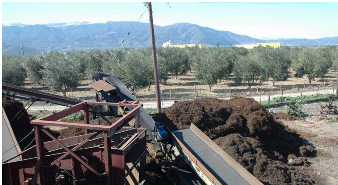
Εικ. 3.3.6: Μονάδα ανακύκλωσης ελαστικών οχημάτων στο Ν. Φθιώτιδος, εντός γεωργικής ζώνης. Διακρίνονται σωροί διαχωρισμένων υλικών (μεταλλικό σύρμα και τρίμμα ελαστικού).
