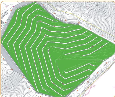
**1. Σχέδιο γενικής διάταξης έργων:** Στο σχέδιο αυτό απεικονίζεται το σύνολο των έργων που κατασκευάζονται για τη σωστή λειτουργία του XYTA. Επίσης απεικονίζεται τη λεκάνη απόθεσης καθώς και το δανειοθάλαμο που θα χρησιμοποιηθεί για την εξοικονόμηση του υλικού ημερήσια κάλυψης των απορριμμάτων. Η λεπτομέρεια των σχεδίων αυτών είναι μικρή καθώς αποτελούν μια γενική άποψη του XYTA σε μικρή συνήθως κλίμακα (1:1000 ή 1:2000).
