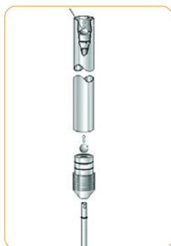
Τυπικό σύστημα δειγματολήπτη υπογείων υδάτων από διακριτά βάθη
