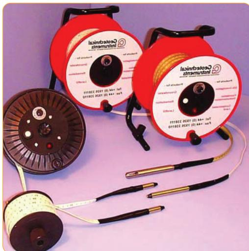
Τυπικό σύστημα μέτρησης στάθμης υπογείων υδάτων
