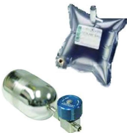
Τυπικές διατάξεις οι οποίες χρησιμοποιούνται για τη δειγματοληψία βιοαερίου και τη μεταφορά του δείγματος σε εργαστήριο
